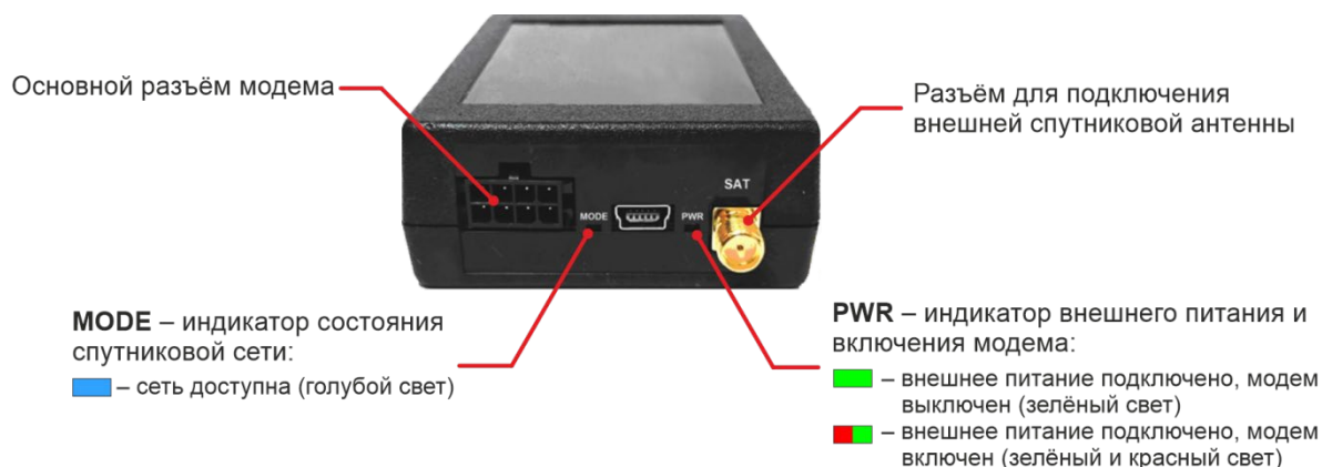
Рис. 4.13. Передняя панель внешнего спутникового модема
